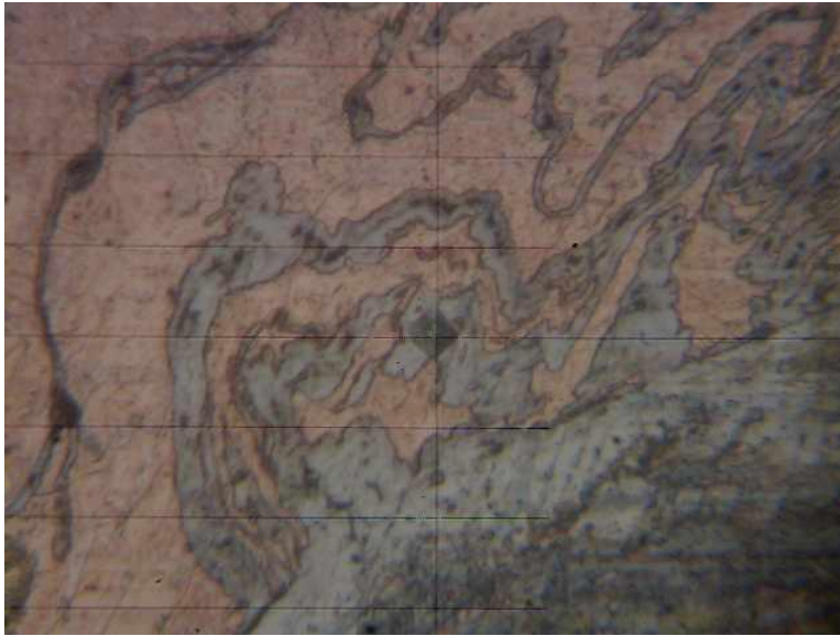
شکل ۴-۲۹ تصویر نقطه متناظر با سختی ۴۳۰ ویکرز در نمونه شماره ۱۲.
